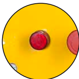
- подсвеченная кнопка «Сеть» указывает, что на станок подается напряжение
