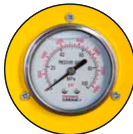
- глицеринонаполненный манометр для более точного съема показаний прибора при вибрации станка
